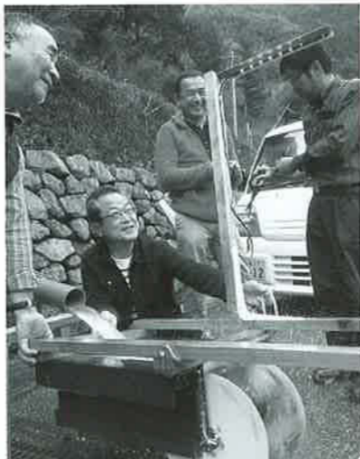
高知小水力利用推進協議会会長とメンバーによる「自転車のハブダイナモを再利用した水車」でのLED点灯実験
