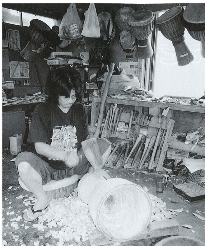
丸太からワイングラス型にジャンベを削り出していく。後方で、上からつるしているのが完成したジャンベ
